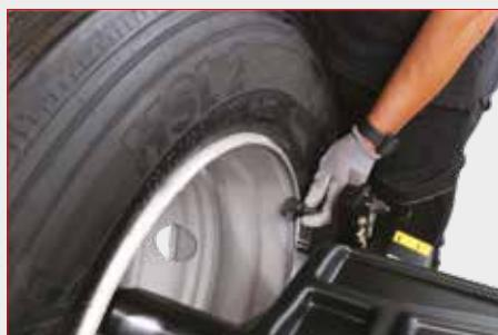
Système intelligent d'acquisition automatique de la distance, diamètre 28" avec fonction intégrée FSP (Fast Selection Program) activant automatiquement les programmes d'équilibrage et ne nécessitant pas de sélections depuis le clavier.
